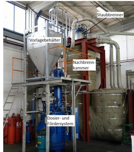
Bild 3: Technikums-Anlage 1MW
